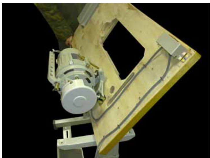
Переворачиваем стол и выравниваем его для закрепления к ногам
