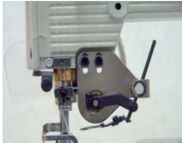
■ EW 電気式上糸払い (電気式ワイパー-NW, NR, NC用) ELECTRIC TYPE WIPER FOR NW, NR, NC DESILIZADOR ELECTRICO PARA NW, NR, NC 电动式上勾线
