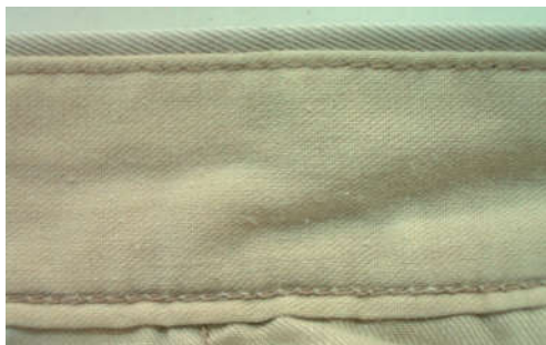
← 本縫 lock stitch / Puntada recta / 平缝线迹
