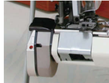
■ CS-2 空環切り装置 (NFS用) ELECTRIC CHAIN CUTTER (For NFS) CORTADOR DE CADENETA PARA NFS 切空线头装置
